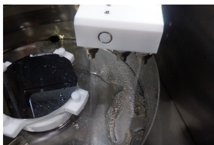
メンテナンスモード 薬液1, リンスを吹出している。
